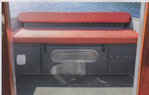
► Inombordaren döljer sig under aktersoffan. Firally var tidiga med inbyggt kapellgarage. Även det finns i aktersoffan.
